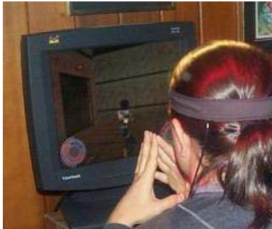
Brainfingers, ett pannband som känner av spelarens muskelrörelser i ansiktet, kan användas även för att spela datorspel.
